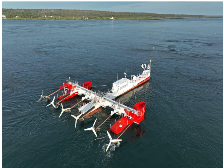
Figura 10 – Plataforma PLAT-I 6.40 instalada na Baía de Fundy, Canadá. Fonte: Kaufman et al. (2023)
